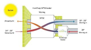
L'air froid est stocké dans l'unité de récupération de chaleur, ce qui transforme cet échangeur de chaleur en un échangeur de fraîcheur.
